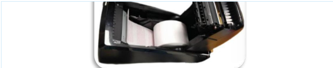
Figura 65: Colocación del rollo nuevo
